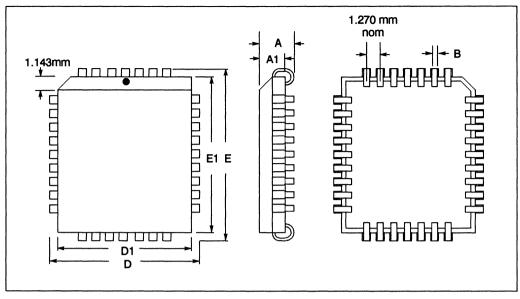
Figure 5.20 32 pin PLCC J-bend package dimensions
