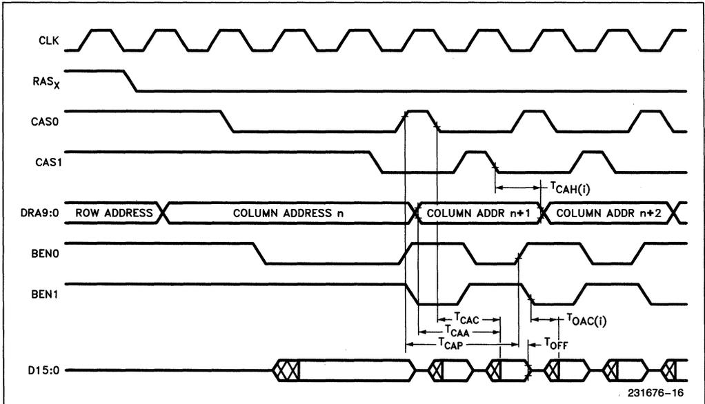
**DRAM SIGNALS—INTERLEAVED FAST PAGE MODE WRITE**
